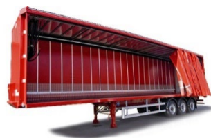
Lastebil eller trailer som kan åpnes for lasting på minst én av sidene.
